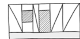
Figure 21. Reforço das paredes nas casas tradicionais da vila de Macuti.
